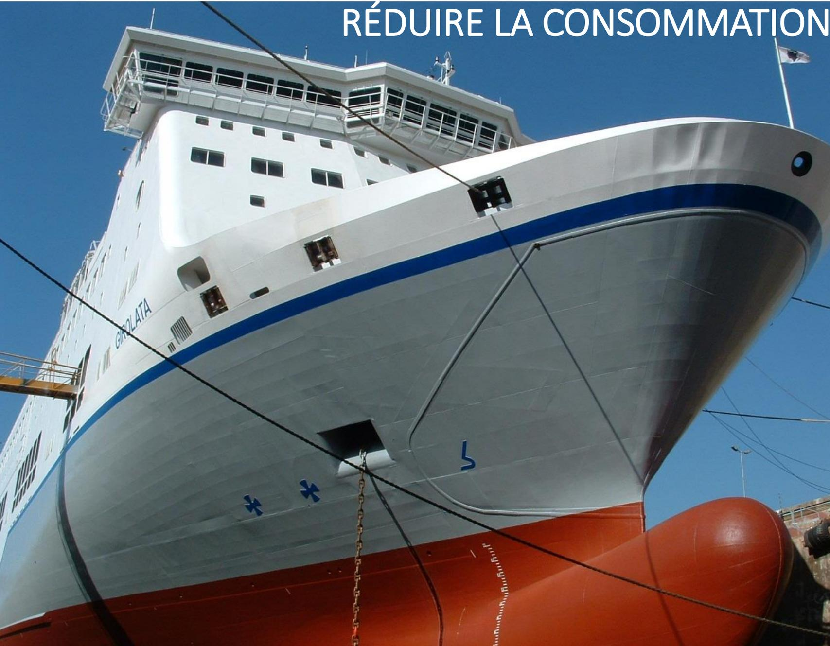
Pour les carènes de navire, les systèmes de revêtement anticorrosion intègrent des propriétés anti-fouling pour des questions techniques et écologiques.
